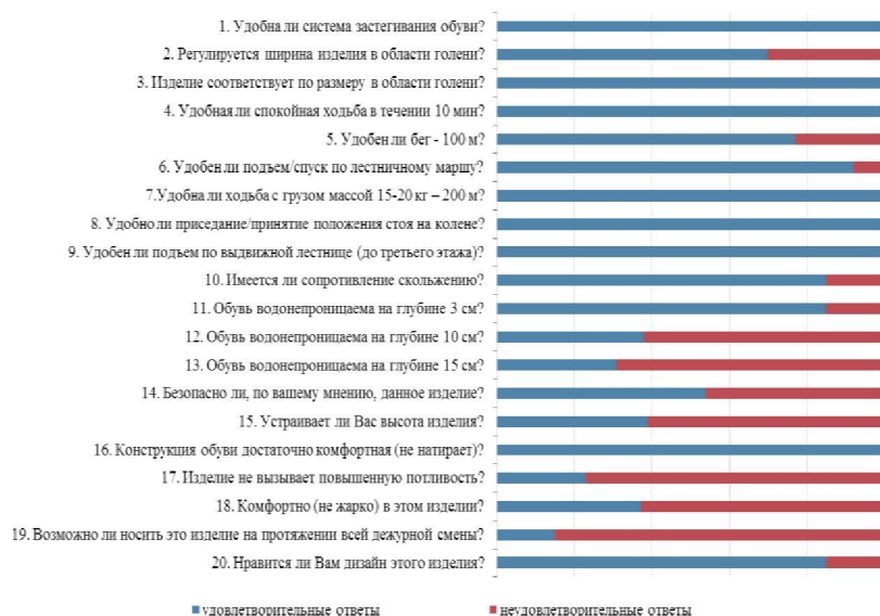
Рисунок 5. – Результаты эксплуатационных испытаний специальной защитной обуви
