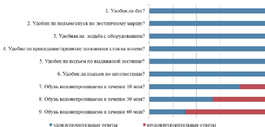
Рисунок 5. – Результаты эксплуатационных испытаний специальной защитной обуви
