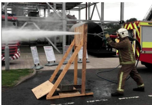
Рисунок 5. – Применение установки пожаротушения ColdCutCobra
