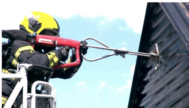
Рисунок 5. – Применение установки пожаротушения ColdCutCobra
