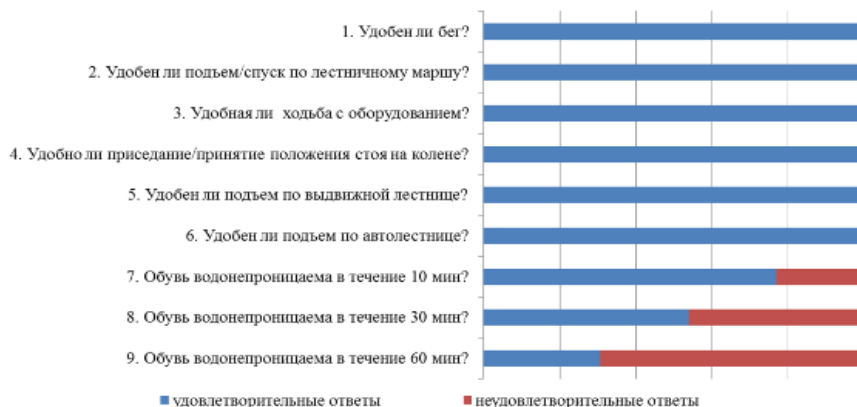
Рисунок 5. – Результаты эксплуатационных испытаний специальной защитной обуви
