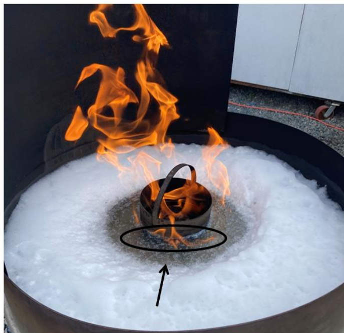
Рисунок 3 – Воспламенение горючего в модельном очаге пожара
