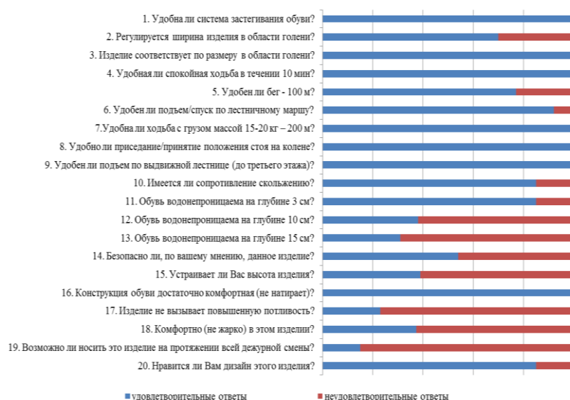
Рисунок 5. – Результаты эксплуатационных испытаний специальной защитной обуви
