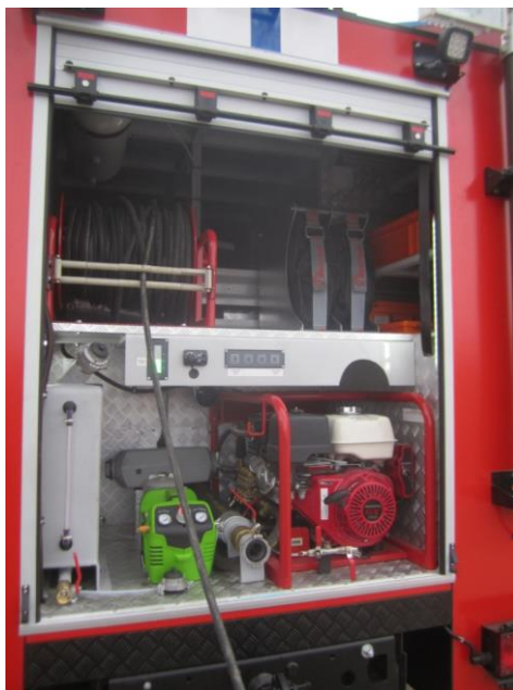
Рисунок 6. – Установка высокого давления Limens в насосном отсеке автомобиля быстрого реагирования
