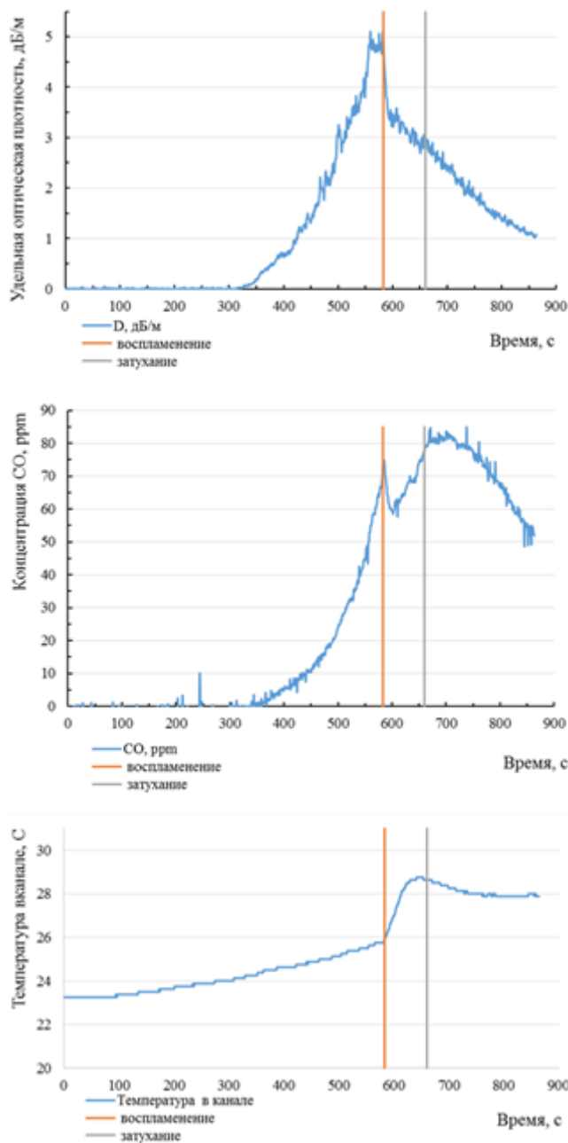
Рисунок 4 – Изменение контролируемых параметров при нагревании образцов хлопковых дисков
