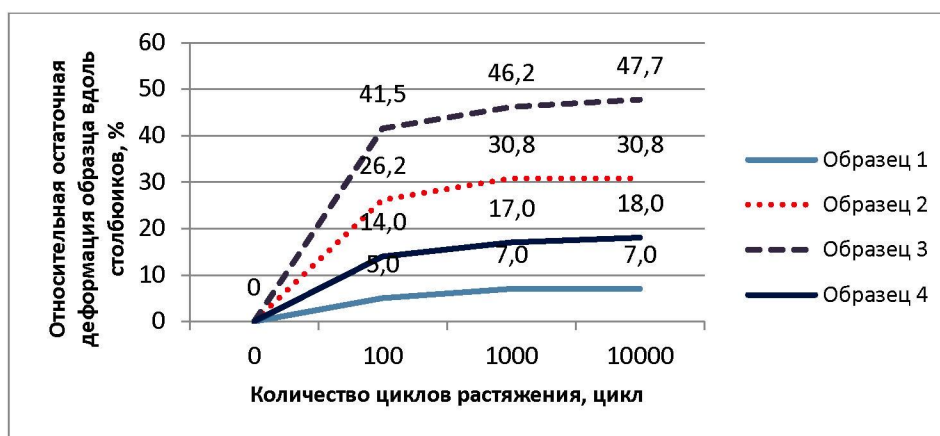
Рисунок 2. – График роста остаточной циклической деформации трикотажных полотен вдоль столбиков
