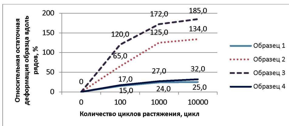
Рисунок 3. – График роста остаточной циклической деформации трикотажных полотен вдоль рядов
