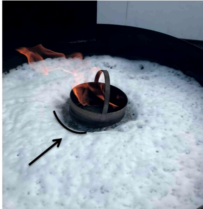
Рисунок 2 – Разрушение пены от высокотемпературного воздействия при горении тигля в модельном очаге пожара
