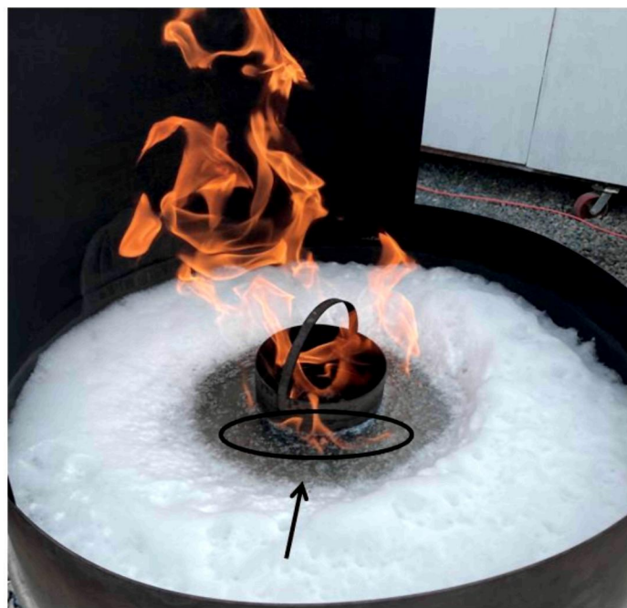
Рисунок 3 – Воспламенение горючего в модельном очаге пожара
