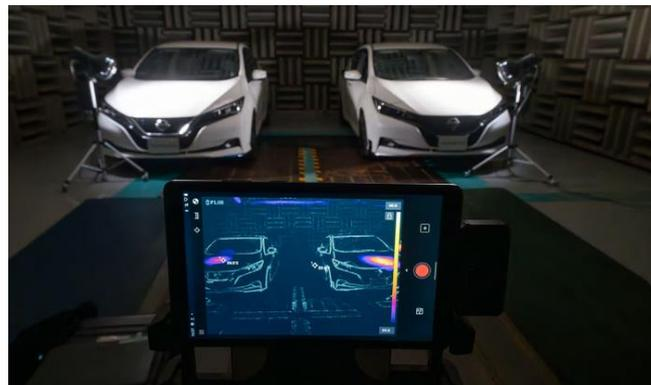
Nissan не торопится раскрывать секрет новой краски, во многом потому, что пока эксперимент проходит неудачно — даже при всех его достижениях. Известно, что покрытие содержит частицы двух типов, первый из которых просто отражает инфракрасное излучение, и тем самым снижает нагрев поверхности. А вот второй, цитата: «создает «электромагнитные волны», которые перенаправляют еще больше энергии от автомобиля и выбрасывают ее прямо в космос». Как это работает — непонятно.
