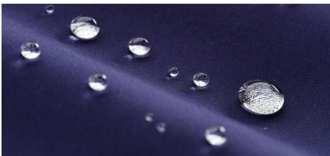
В результате это первая в мире водонепроницаемая ткань Polartec, способность которой превышает 20 000 мм при испытании гидростатическим давлением на водонепроницаемость, а показатель пропускания паров влаги 20 000 г/м<sup>2</sup> обеспечивает воздухопроницаемость в течение 24 часов.
