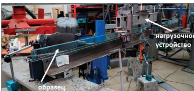
Рис. 2. Балка на испытательном стенде
