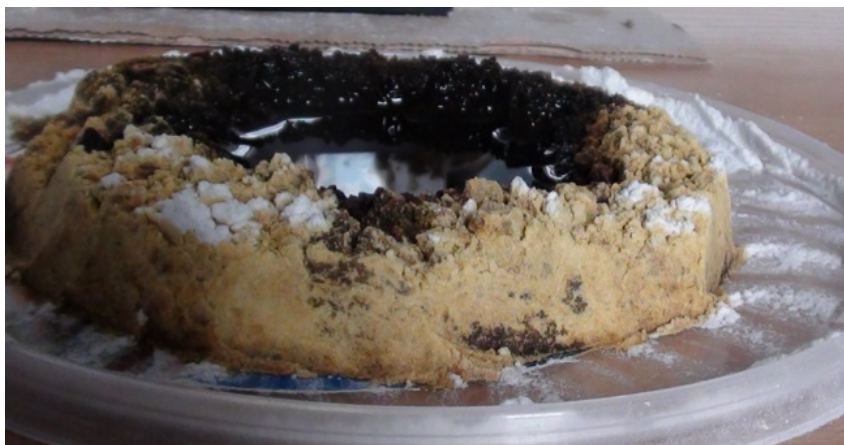
Рисунок 2. – Нефть внутри кольцевой обваловки из ДГСК
