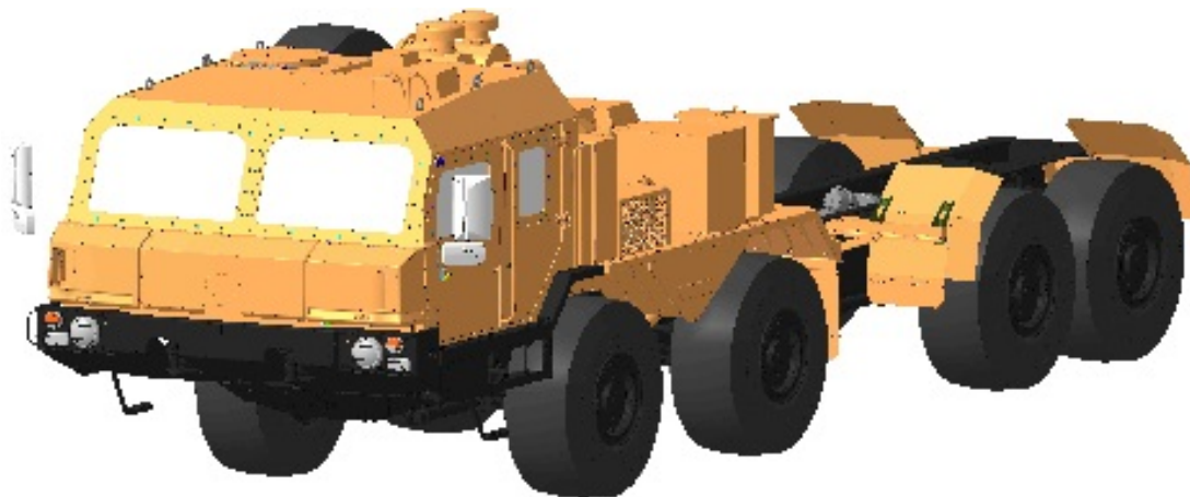
Рисунок 5. – Новый образец базового шасси повышенной проходимости БАЗ-6910(690902М) с увеличенной кабиной для монтажа различного технологического оборудования аварийно-спасательных и поисково-спасательных машин для проведения работ в условиях Крайнего Севера в Арктической зоне РФ
