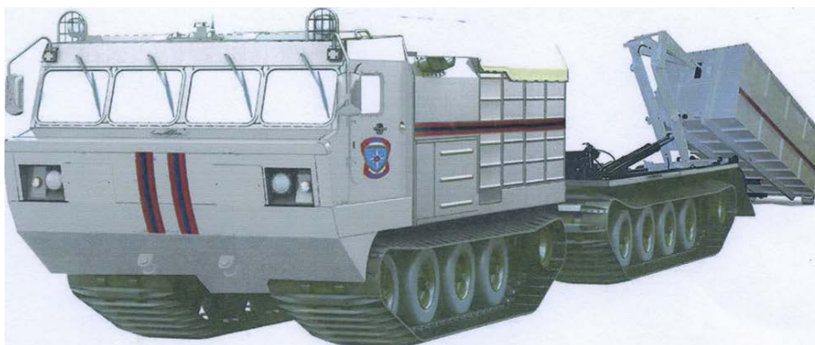
Рисунок 2. – Аварийно-спасательная машина повышенной проходимости модульного принципа компоновки (сменные модули контейнерного типа: аварийно-спасательные, поисково-спасательные, пожарно-спасательные и др.) с погрузочно-разгрузочным механизмом (мультилифт) на базе шарнирно-сочлененного гусеничного транспортера ДТ-10ПМ производства АО «МК «Витязь»
