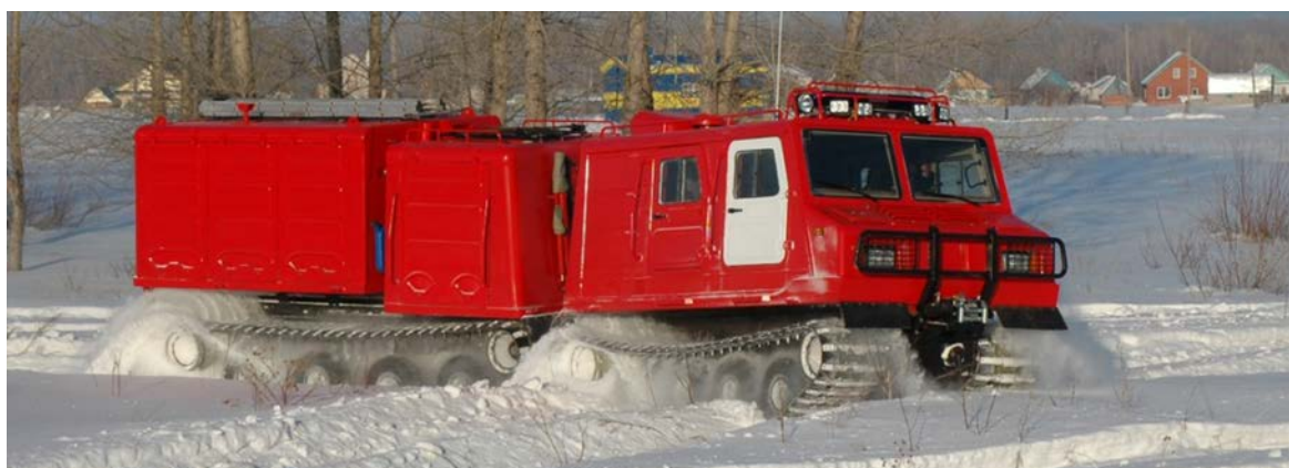
Рисунок 3. – Пожарно-спасательная машина повышенной проходимости модульного принципа компоновки ДТП – ЗПСА (сменные модули контейнерного типа: пожарно-спасательные, командно-штабные, поисково-спасательные, медицинские) с погрузочно-разгрузочным механизмом (мультилифт) на базе шарнирно-сочлененного гусеничного транспортера ДТ-3ПМ производства завода АО «МК «Витязь»
