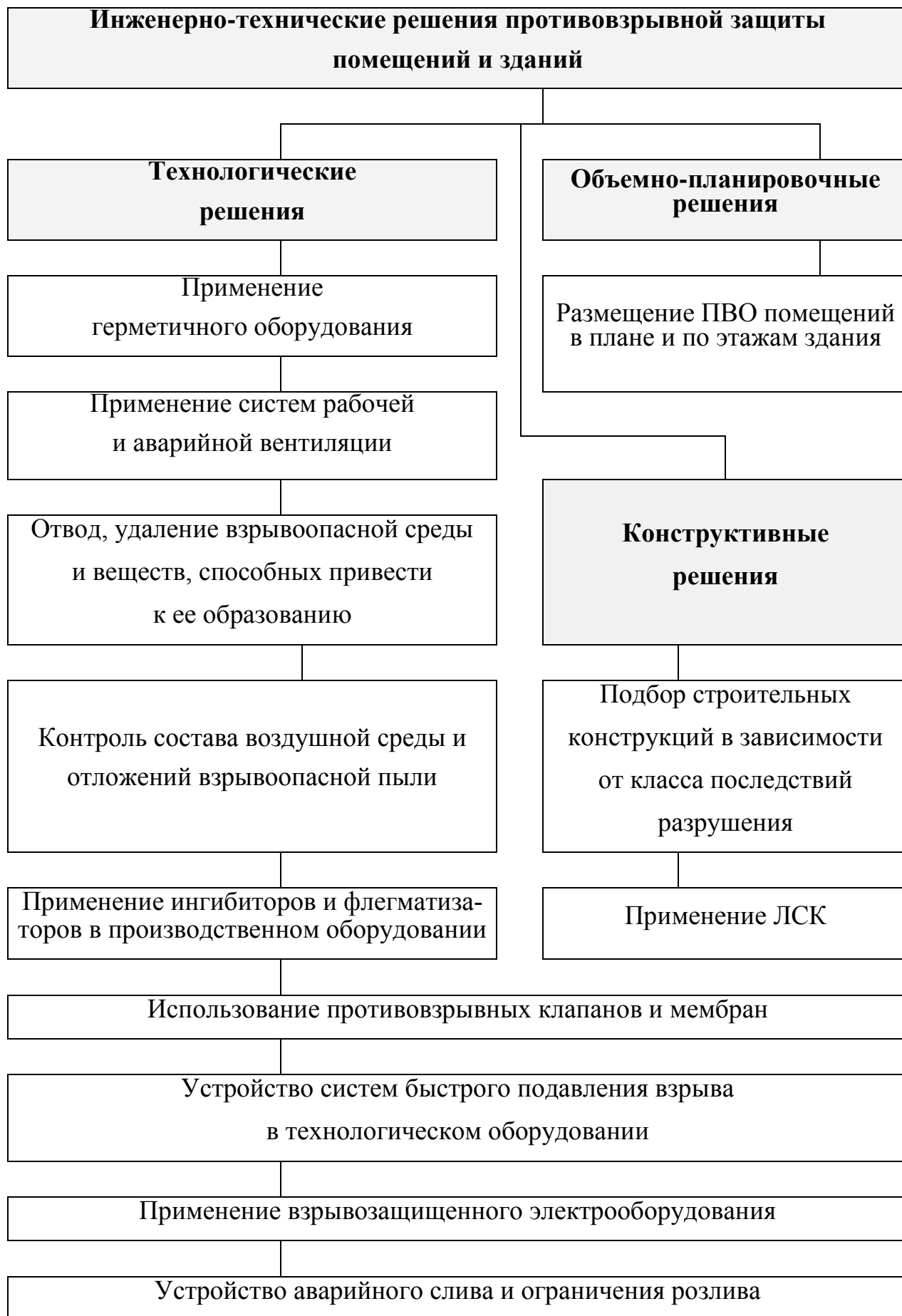
Рисунок 3. – Инженерно-технические решения противовзрывной защиты помещений и зданий
