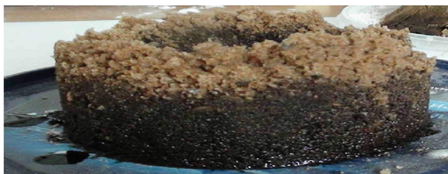
Рисунок 3. – Нефть внутри кольцевой обваловки из песка
