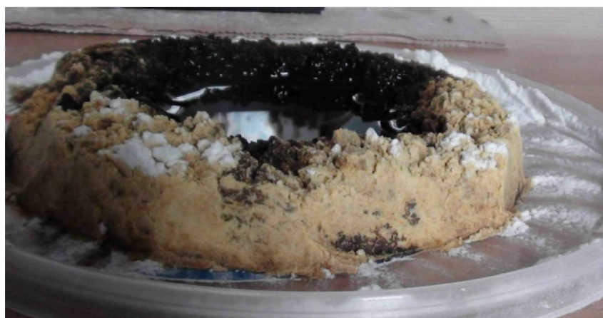
Рисунок 2. – Нефть внутри кольцевой обваловки из ДГСК
