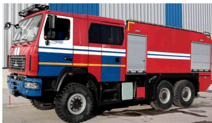
Рисунок 1 – Облегченная пожарная автоцистерна АЦ 8,0-40 (6302) на базе шасси МАЗ с централизованной подкачкой шин
