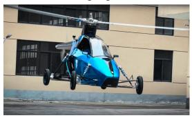
Машина хранит много загадок. В частности, не до конца понятно, как работает электрическая составляющая гибридной системы привода. Скорее всего, основной движущей силой является Pegasus двухтактный движок мощностью 160 л. с. Вес машины без топлива и нагрузки — 265 кг, вместе с ней
