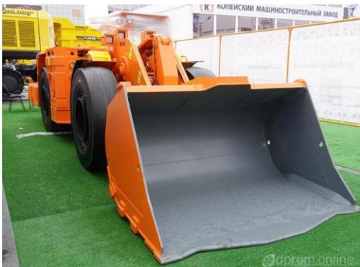
платформой, лебёдкой и иным сменным оборудованием. Такие ПДМ уже используются в гипсовых и соляных шахтах.
