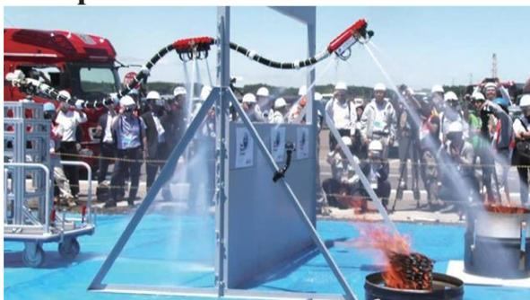
Японские исследователи разработали и опубликовали в открытом доступе проект летающего пожарного шланга. Он левитирует и направляется для тушения пожара, используя собственное давление воды в качестве двухкомпонентной двигательной системы. Он распыляет
