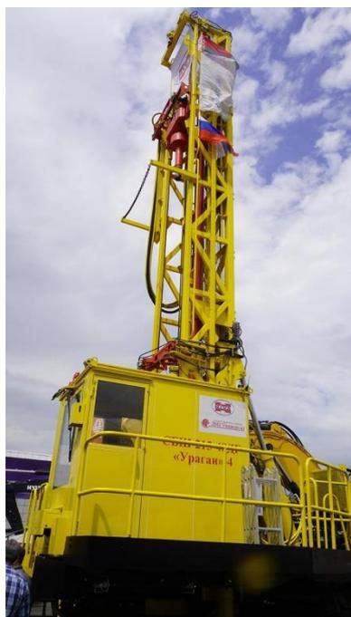
Следующий выставочный образец удивил ещё больше: в Новокузнецк «Нива-Холдинг» привезла полноразмерный буровой станок СБШ-215-48 ДГ «Ураган» — оборудование производства ОАО «ЛМЗ «Универсал». Это манёвренная самоходная машина вращательного бурения с гидроприводом и дизельным двигателем, задействованная в цикле БВР на объектах открытых горных работ.
