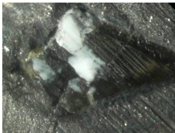
Рисунок 6 – Площадка износа кристалла алмаза с образовавшимися трещинами
