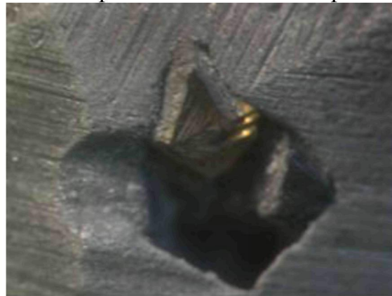
Рисунок 6 – Площадка износа кристалла алмаза с образовавшимися трещинами
