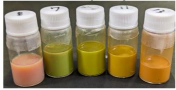
Основой нового покрытия являются сферы из кристаллического кремния нанометрового размера. Благодаря «резонансу Ми» они отражают свет во всех направлениях, НО на определенных длинах волн. Меняя диаметр сфер, онжом
