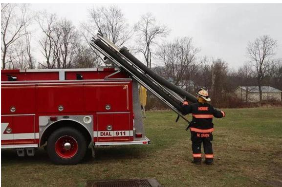
Новое устройство для транспортировки и использования всасывающих рукавов от Ziamatic может быть самым безопасным и эффективным способом извлечения двух 10-футовых всасывающих рукавов с крыши пожарной машины. Данное устройство превращает операцию с участием нескольких человек в операцию с участием одного человека.
