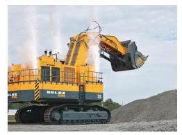
Опытный образец карьерного экскаватора BELAZ BX20012 класса 200 тонн оснащен 12-кубовым ковшом типа «прямая лопата» и спроектирован с учетом современного инженерного подхода. Своим функционалом и надежной конструкцией, эксплуатационными характеристиками и высокой степенью безопасности он получился под стать лучшим мировым аналогам.
