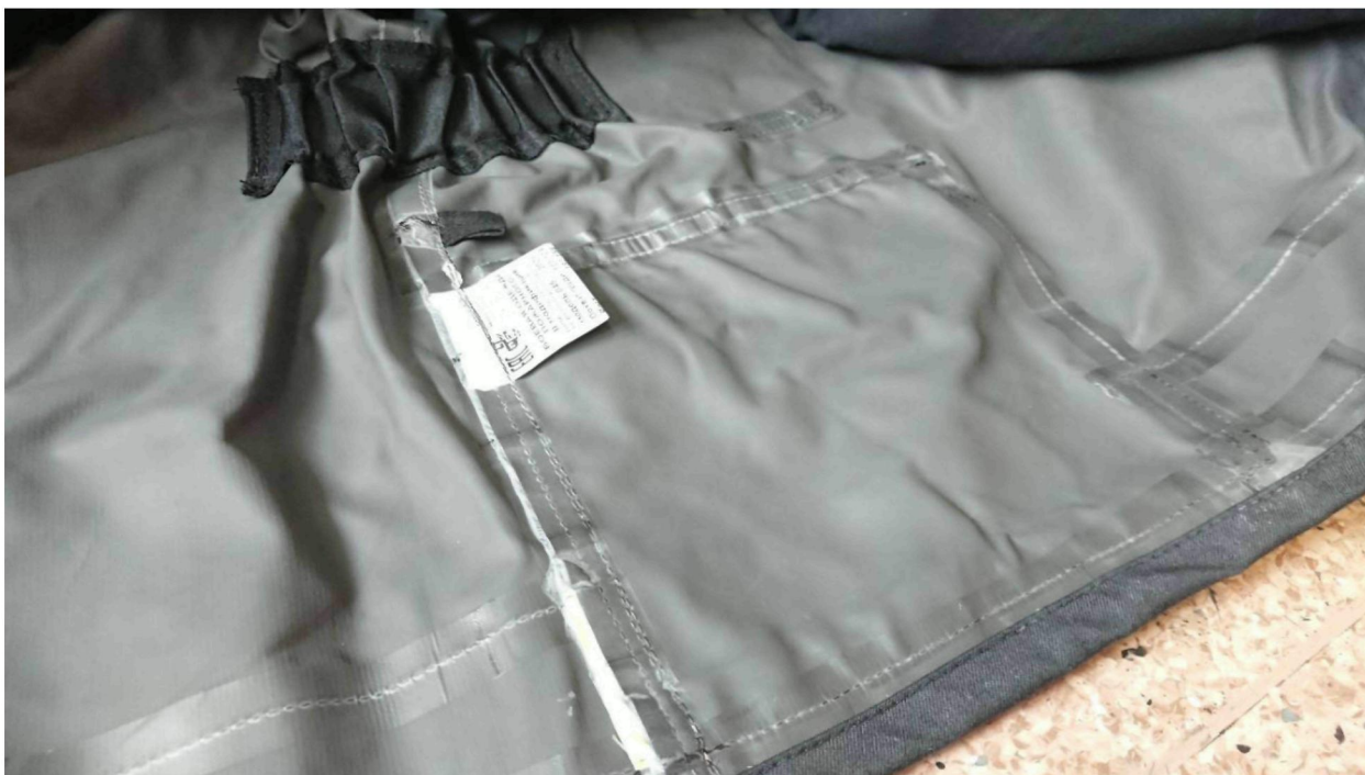
Рисунок 1. – Общий вид ткани арселеновой огнезащитной с водоупорной отделкой с изнаночной стороны в составе БОП
