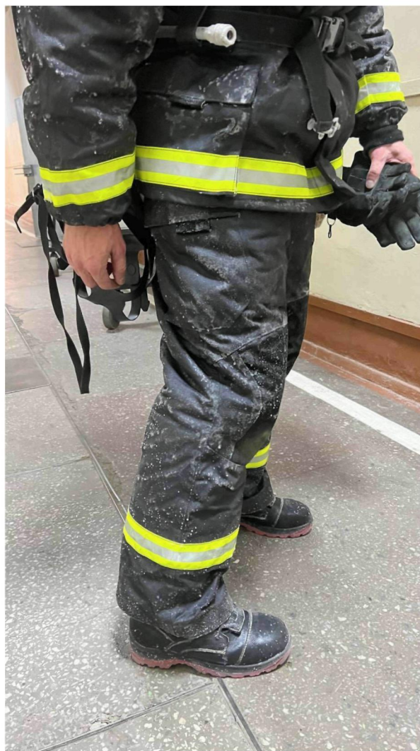
Рисунок 3. – Внешний вид БОП при намокании при температуре -40\text{ }^{\circ}\text{C}
