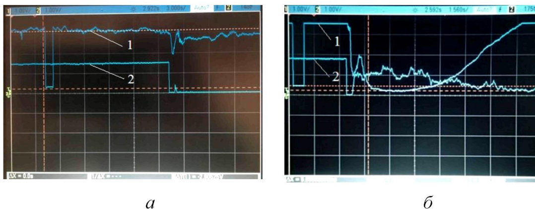
Рисунок 4 – Осциллограммы сигналов измерения оптической плотности порошковой аэрозоли 1 и длительности выпуска огнетушащего порошка 2 из резервуара ЛУПП
