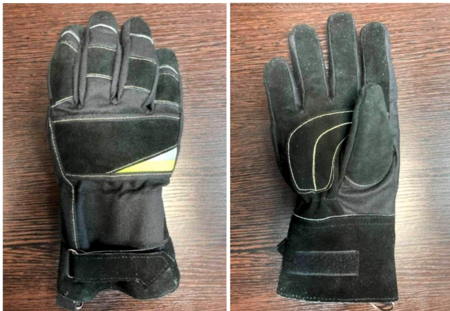
Рисунок 1 – Экспериментальный образец СИЗР пожарного
