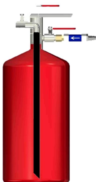
Рисунок 5 – Вид конструкции устройства пожаротушения порошковыми составами
