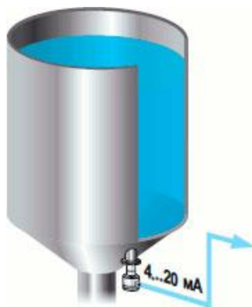
Рисунок 1. – Реализация гидростатического метода измерения
