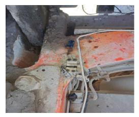
шахтных автосамосвалов (ШАС) и эрозия (нержавеющей материала тензодатчиков стали) из-за агрессивной среды в шахте.
