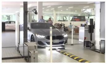
Руководство сканирование. проекта поясняет, что ранее проверка и поиск дефектов велись вручную, ЧТО занимало времени, а теперь на это уходит 5 Автомобиль секунд. не нужно готовить к осмотру, он просто проезжает через специальный сканер. Технология базе на искусственного интеллекта
