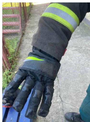
Рисунок 3 – Совместимость СИЗР с конструкцией рукавов БОП
