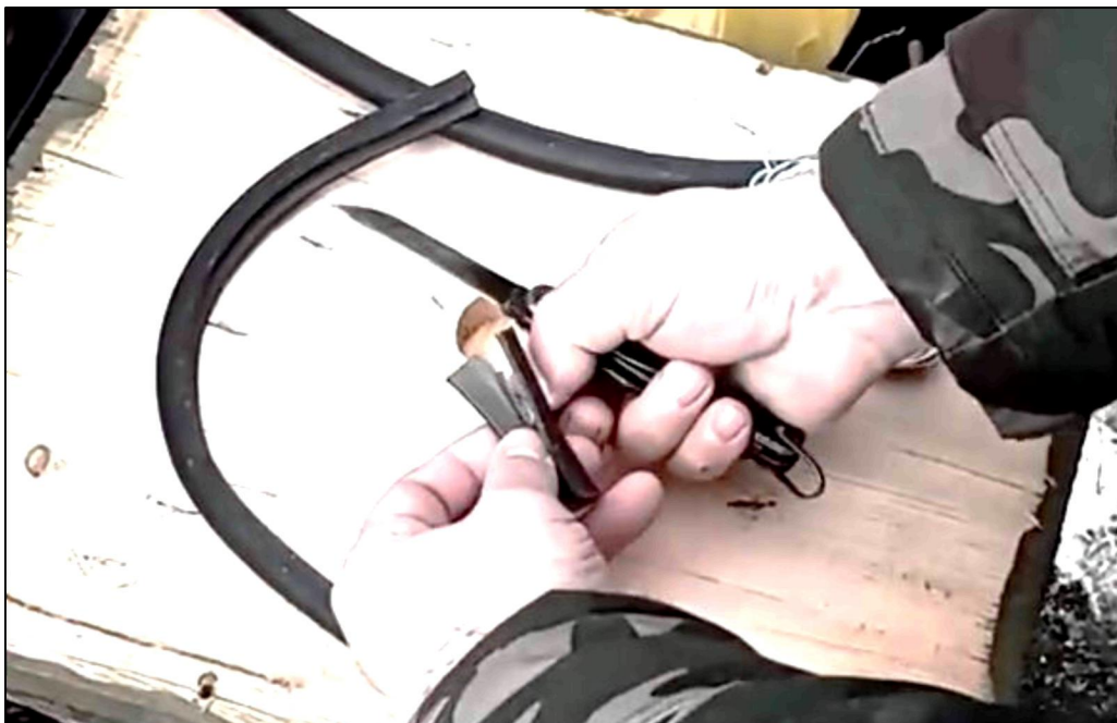
Рисунок 5 – Выполненная продольная прорезь в ШКЗ
