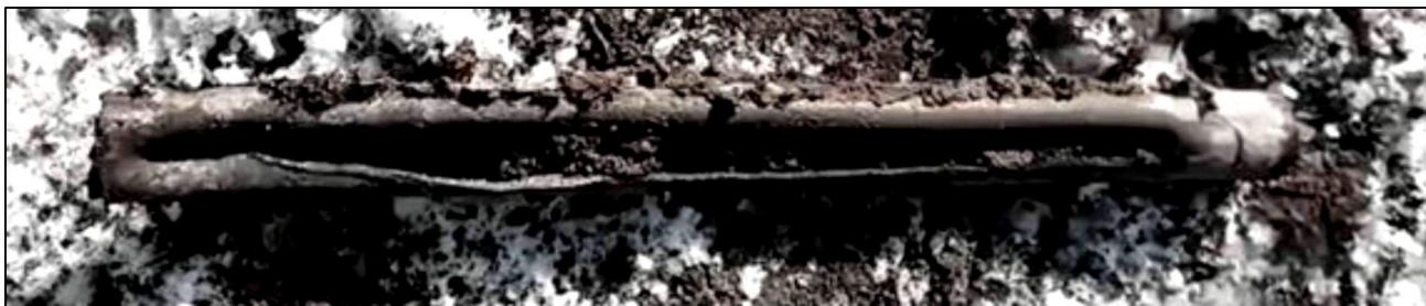
Рисунок 7 – Результат взрыва заряда ШКЗ, когда электродетонатор монтировался в прорезь отрезка ШКЗ в торце шнура
